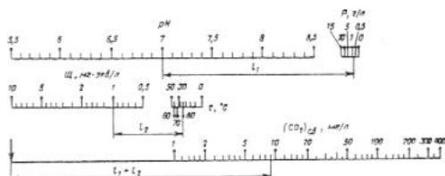
Рис. 2. Номограмма для определения концентрации свободной двуокиси углерода в природной воде (или  $\text{pH}$ )
