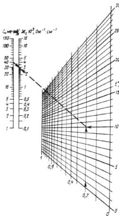
**Пример.** Дано:  $C = 40 \text{ мг-экв/л}$ ;  $[SO_4^{2-}] / SA = 0,2$ ;  $t = 10^\circ\text{C}$ .
