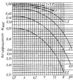
**Рис. 3 Номограмма для определения коэффициента  $a_{\text{кис}}$  при расчете дозы кислоты**
